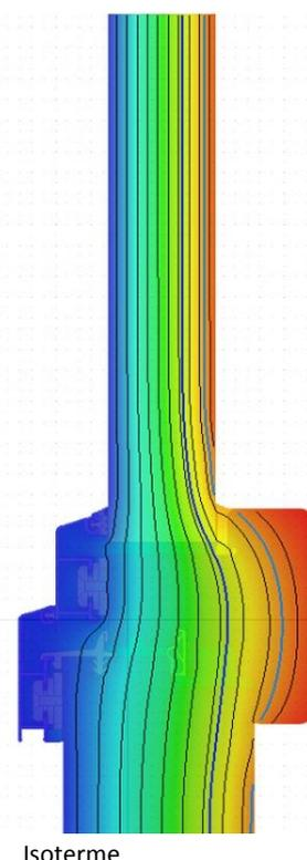
NOTE: Calcolato come da UNI EN ISO 12567-1:2010 (Finestra 1 anta 1230x1480 mm) (Portafinestra 1 anta 1480x2180mm).  $U_g = 0,6 \text{ W/m}^2\text{K}$  e  $\gamma = 0,04 \text{ Wm}^2\text{K}$ . Dati di progetto: temperatura esterna di  $0^\circ\text{C}$  temperatura interna di  $20^\circ\text{C}$  e 65% di umidità.
